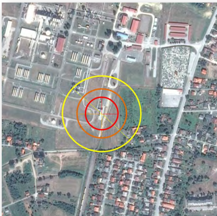
Slika 6.5.-5. – Zone utjecaja u slučaju požara
