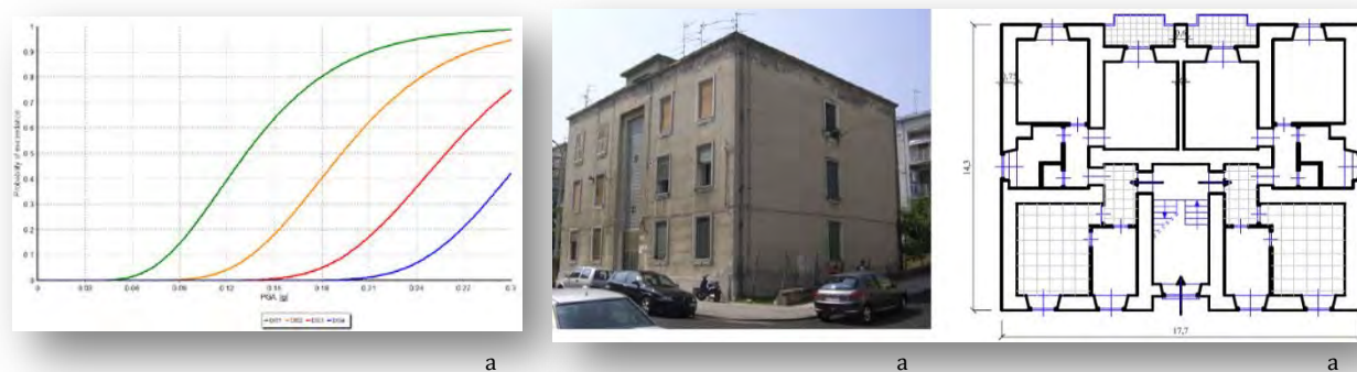
Slika 6.7.16. – Primjer skupa krivulja ranjivosti za karakteristični tip zidane građevine (a); Pogled (b); Tlocrt (c) [72, 74]
