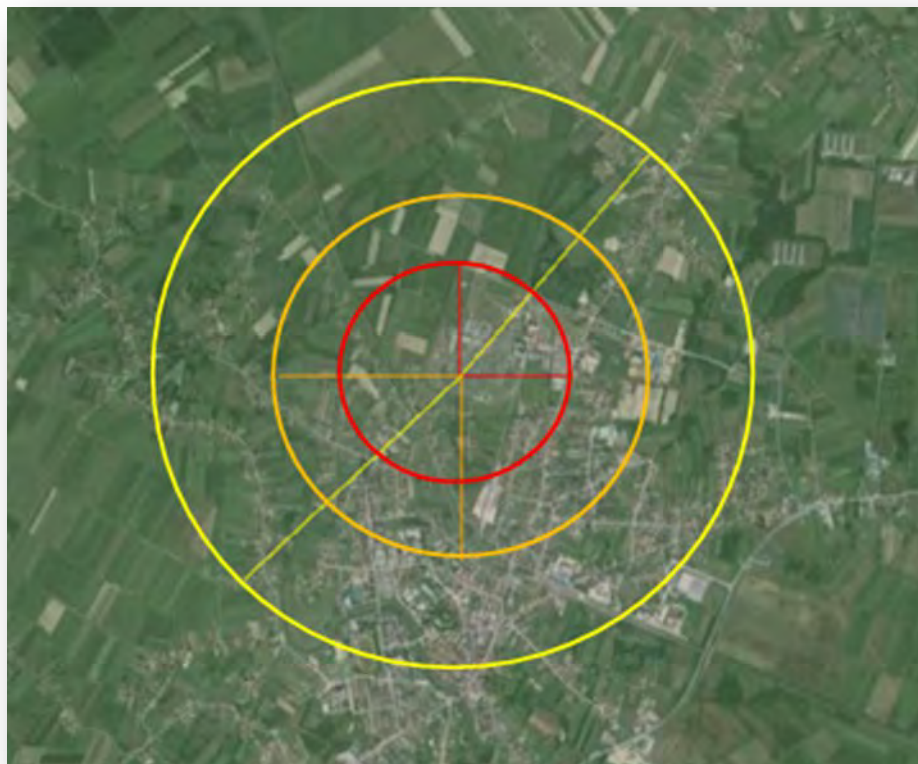
Slika 6.5.-8. – Zone utjecaja u slučaju požara
